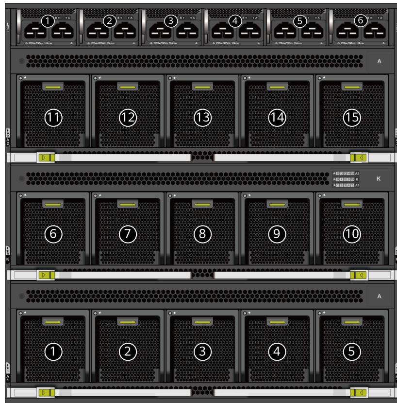
如图2-5所示，最上层①~⑥为电源模块，下面三层①~⑯为风扇模块。
